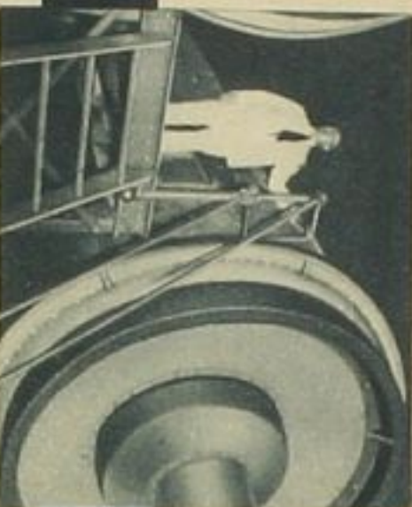
発 芽 槽 適量に水浸した大麦をこの中へ移し、約八日間ほど所要の温度と湿度とを興へ、芽と根が適量の長さになり、乾燥槽へ送ります。
